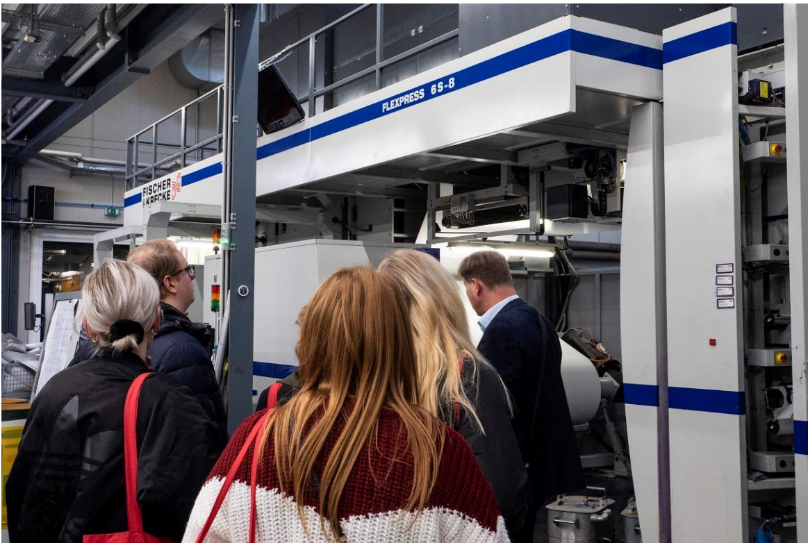
Huippukorkeakouluissa on panostettu painotekniikan laboratorioihin. Esimerkiksi Hochschule der Medien -korkeakoulussa flexopainokonetta käytetään sekä opetuksessa että yrityksille tehtävissä testiajoissa.
